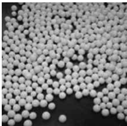
Рис. 15.3. Диаметр адсорбирующих гранул — 2 мм
